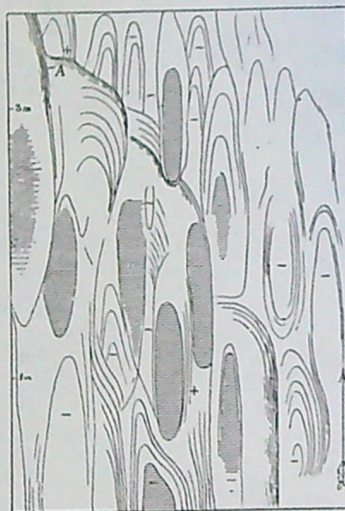
118. ábra. Elliptikus mélyedések alakjában történt kifúvások kemény hóban (1903 január). A helyen a magasságkülönbség 15 cm.
